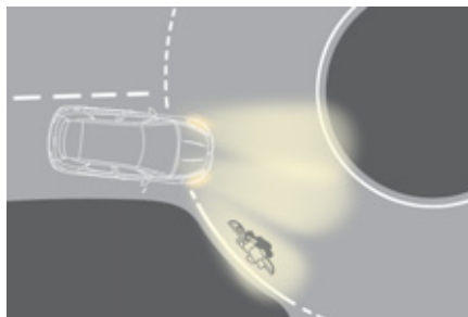
cu iluminat static de intersectie
